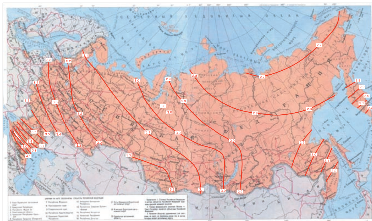
Районирование территории России по эффективности использования низкотенциальной тепловой энергии поверхностных слоев земли
